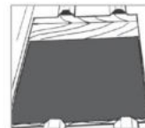
4. A 30 mm-es vonalon belül vágja ki a tetőt. Sorjázza le az éles széleket. A tetőkivágás stabilizálásához, ahol szükséges, szereljük fel a kiváltó gerendákat.
