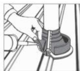
4. Vigye fel a tömítőanyagot, és a Dektite-et formálja rá a tetőlemeze.
