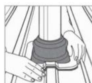
4. A Dektite-et pontosan formálja rá a profilmezére.
