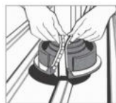
2. A Dektite-et fedtesse a csőre és a fémszárat illesse össze (fentről lefele).
