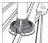
5. Rögzítse a Dektite-et önfúró csavarral vagy Bulb-tite szegeccsel
