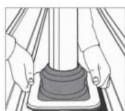
2. Illesse és jelölje a Dektite-et a profilmezén.
