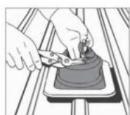
1. Illesse a Dektite-et a csőhöz.
