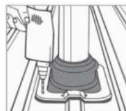
4. Rögzítse a Dektite-et önfúró csavarokkal vagy Bulb-tite szegecsekkel.
