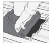
5. Vigye fel a tömítőanyagot és a Dektite-et formázza a tetőprofilra.
