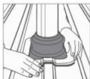
3. A Dektite illessze rá a tetőprofilra.
