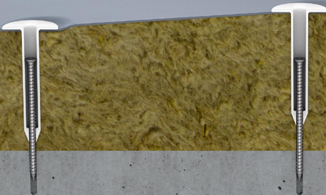
Flachdächer sind in der Regel nicht ganz flach, sondern haben ein Mindestgefälle von 2 %, damit Regenwasser gezielt ablaufen kann. Bei einer Gefälledämmung muss der Monteur zur Befestigung der Dichtungsbahn für jede Dämmstoffstärke einen entsprechend langen Befestiger verwenden. Einfacher und wirtschaftlicher sind Flachdachbefestiger, die in der Höhe justierbar sind. Wie beispielsweise der EJOT JBS-R/EcoTek.
