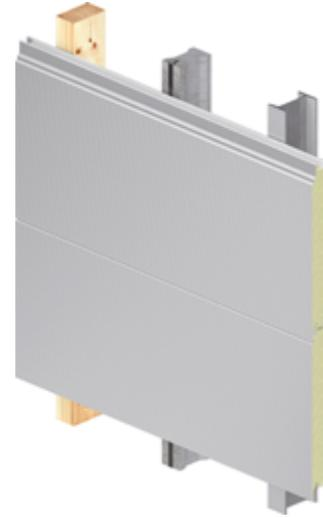
Vorgehängte hinterlüftete Fassade (VHF)
